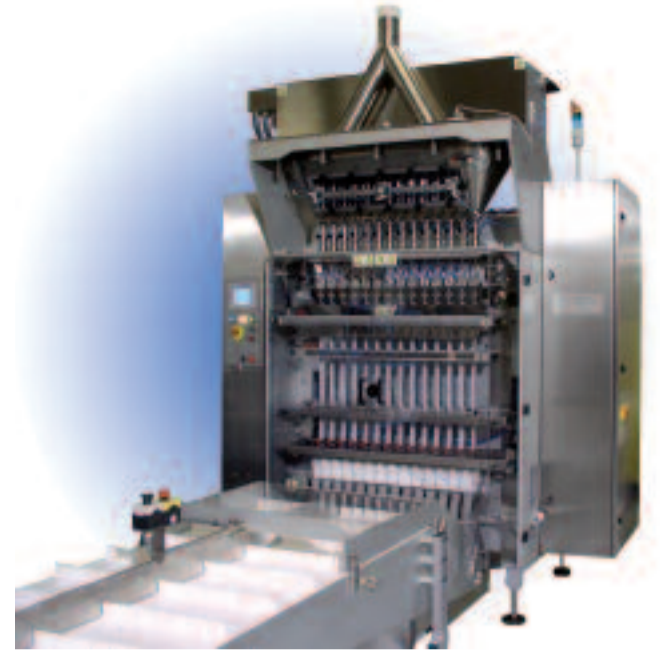
TUBE-S, macchina confezionatrice a 16 linee progettata per confezionare stick (buste sigillate su 3 lati). Prodotta con larghezza bobina pari a 1.000 mm, ma disponibile anche nella versione 1.200 mm, può supportare più dosatori
